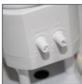
ST75: potencjometry TIME, LUX
